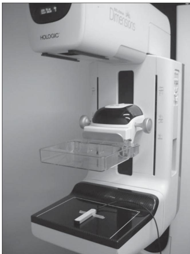
**Figura 2.** Posicionamento do detector de estado sólido para medições de  $K_i$  e CSR.
